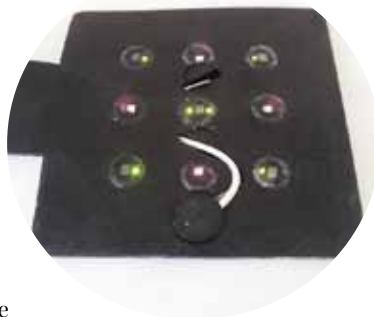
Den flexibla silikonplattan för att läsa av blodflödet hos patienten finns än så länge bara i ett exemplar.
